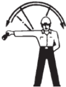
PRECAUCIÓN – Mueve una bandera Haz señas de luz en forma de medio círculo con el brazo sobre la cabeza:
