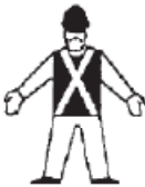
Mueve hacia atrás Los brazos hacia abajo Utilizando movimiento de empuje
