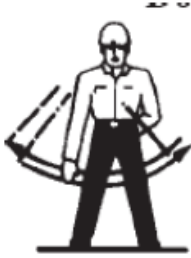
STOP – Para atrás y para adelante Por encima del pecho y Movimiento de balanceo
