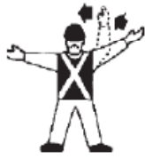
Mueve hacia la izquierda Brazo derecho extendido y brazo izquierdo se mueve rápidamente hacia arriba
