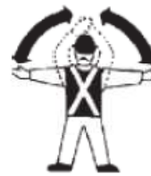
Levantamiento de brazos No aterrizar Levanta los brazos y Crúzalos con la cabeza
